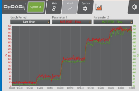
图形视图 可以显示两组数据进行性能比较
