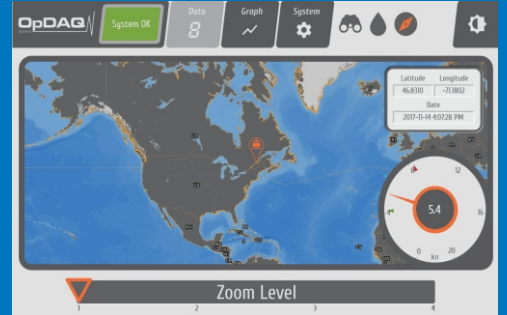
地图视图 实时显示船舶位置和对地速度
