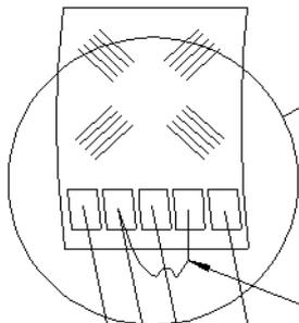
YIELDS POSITIVE OUTPUT SIGNAL FOR TORQUE DIRECTION SHOWN.
